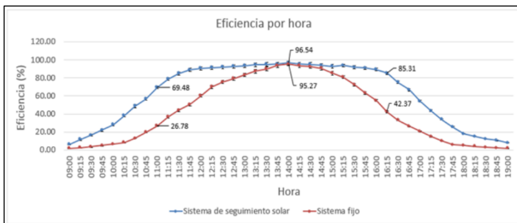
Figura 36: Comparativo rendimiento de un sistema con y sin seguidor solar
