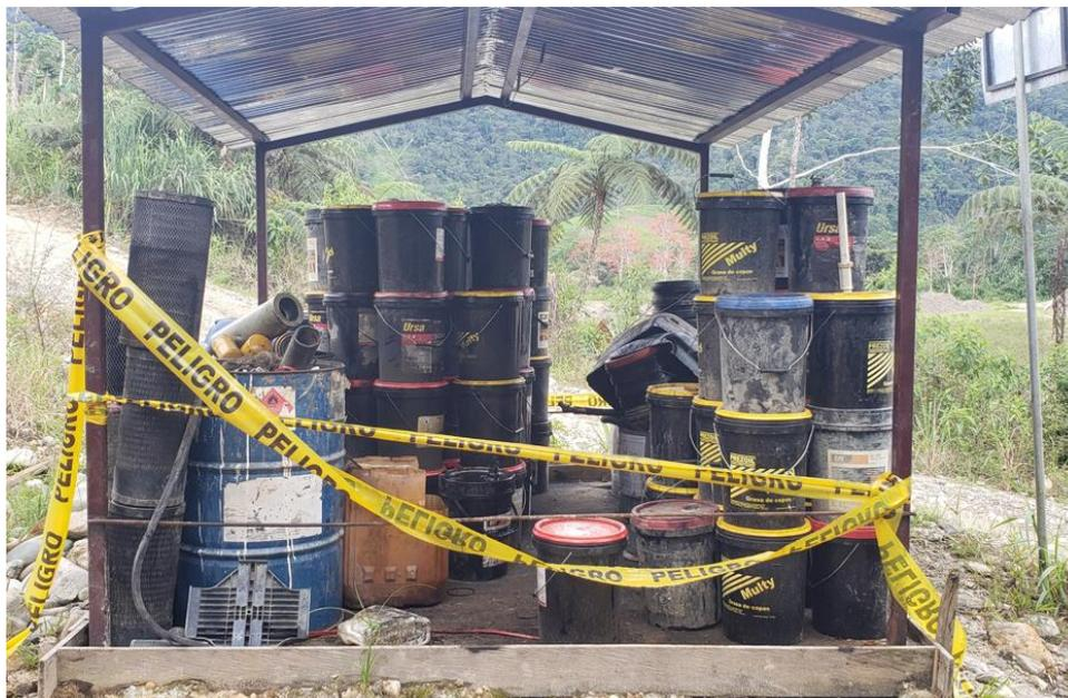
*Nota:* En la figura se indica el espacio físico dentro de la concesión minera Linder, en el cual se acumulan los residuos peligrosos que se generan por el mantenimiento preventivo y correctivo de la maquinaria.
