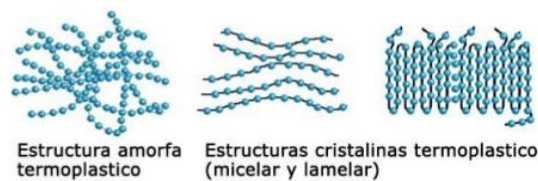
Figura 12.- Estructuras Termoplásticos (Rosas, 2014)
