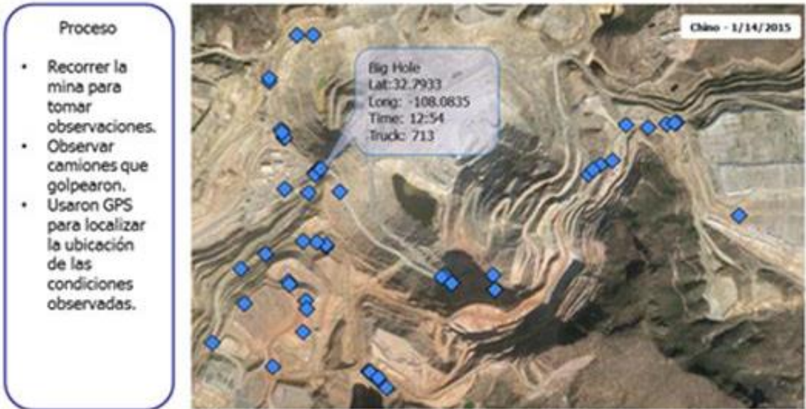
Figura 3. Observaciones en las vías de la mina para la identificación de puntos negativos Fuente Cerro Verde
