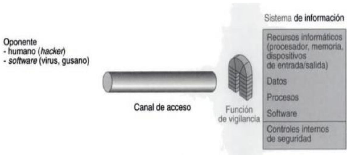
Figura 2. Modelo para la seguridad en el acceso a redes. Reimpreso de Fundamentos de seguridad en redes. Copyright por William Stallings (2004)
