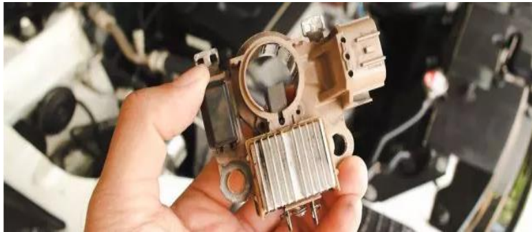
Rectificador de Tensión
