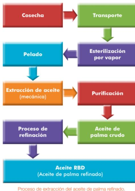
**Figura 2. Proceso de extracción del aceite de palma refinado**
