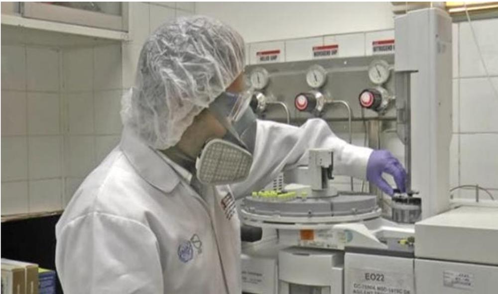
Nota. Extractos de las muestras en el Autosampler del cromatógrafo. Elaboración propia.
